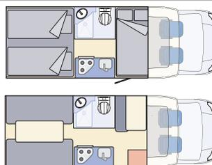
**Technische Daten:** Dieselmotor 115 PS mit Schaltgetriebe. Fahrzeugmaße (LxBxH): 6,9 m x 2,3 m x 2,8 m. Bettgrößen: 2,1 m x 1,4 m (hinten), 2,0 m x 1,2 m (Mitte).
