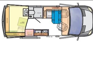
**Technische Daten:** Dieselmotor mit Automatikgetriebe (Verbrauch ca. 12 l / 100 km) und Allradantrieb. Fahrzeugmaße (LxBxH): 5,9 m x 2,0 m x 2,8 m. Bettgröße: 1,9 m x 1,4 m.
