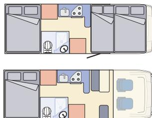
**Technische Daten:** Dieselmotor 130 PS mit Schaltgetriebe. Fahrzeugmaße (LxBxH): 7,0 m x 2,3 m x 3,2 m. Bettgrößen: 2,0 m x 1,6 m (Alkoven), 2,1 m x 1,4 m (hinten), 1,8 m x 1,0 m (Mitte).
