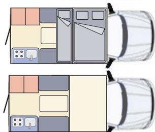
**Technische Daten:** Dieselmotor mit Schaltgetriebe und Allradantrieb. Fahrzeugmaße (LxBxH): 5,3 m x 1,9 m x 2,3-2,8 m. Bettgröße: 1,9 m x 1,2 m (Alkoven), 1,9 m x 0,8 (unten). Zwei Personen schlafen oben, Tisch und Bänke lassen sich zu einem zweiten Bett umbauen.
